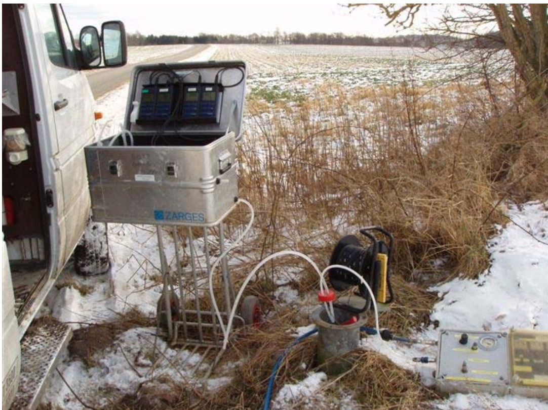
Figur 5. Eksempel på opstilling af udstyr til feltmålinger ved en montejustpumpe. Bemærk automatikboks på jorden til at styre prøvetagningen.
