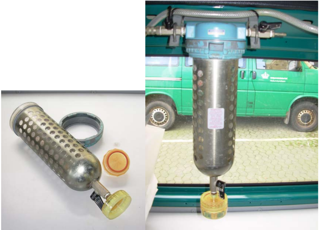
Figur 3. Trykfiltreringsudstyr fra LOOP og borerer med utilstrækkeligt pumpetryk, her filterhus og filterholder, samt opstilling i feltbilen, med gas til trykfiltrering monteret.
