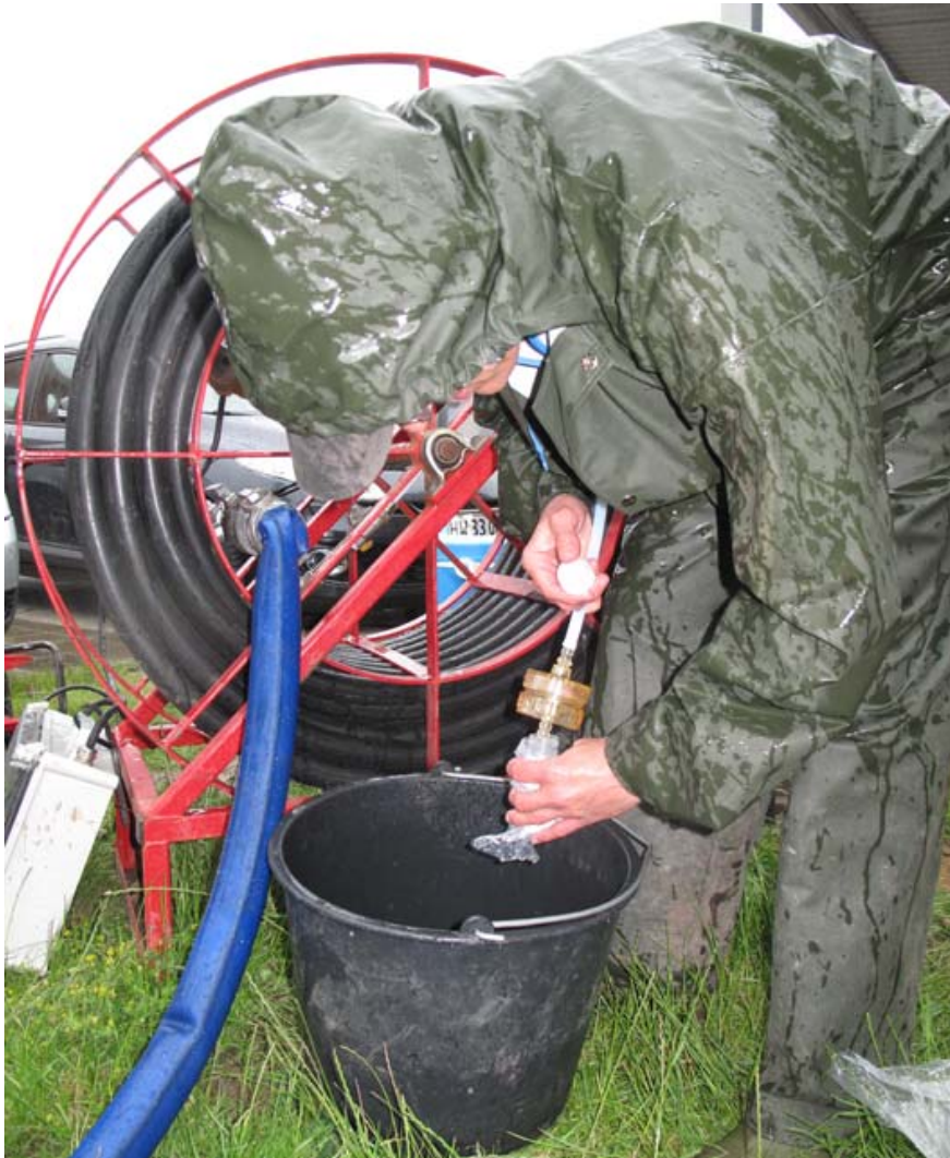
Figur 2. Online filtrering ved hjælp af pumpetryk.
