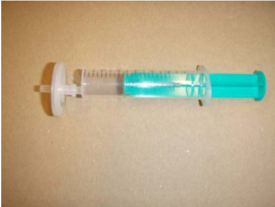
Figur 4. Filtrering med håndsprøjte (Billede lånt fra S01, Teknisk anvisning for feltmålinger og vandkemi i søer)
