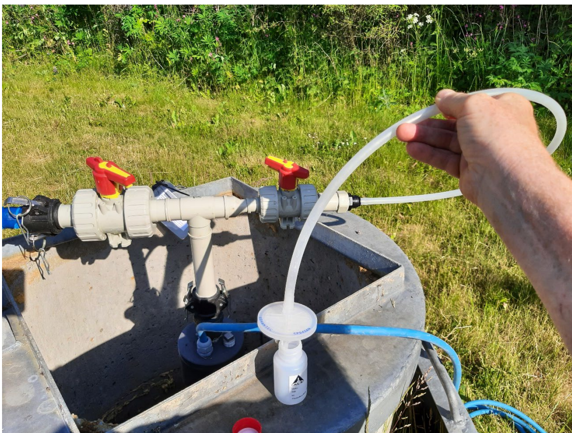
Figur 2. Online filtrering gennem engangsfiltre ved hjælp af pumpetryk.
