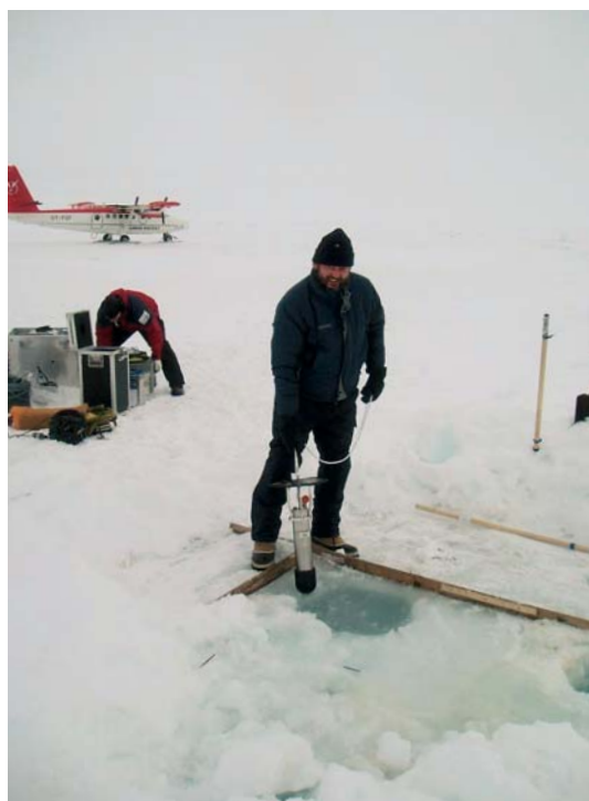
Morten Sølvsten fra Farvandsvæsnet måler lydets hastighed i vandet under isen for at kortlægge havets nøjagtige dybder.
