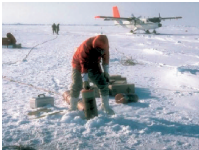
1. Sprængstoffet er specielt fremstillet, så det kan gå ned i et borehul med en diameter på 25 cm.
