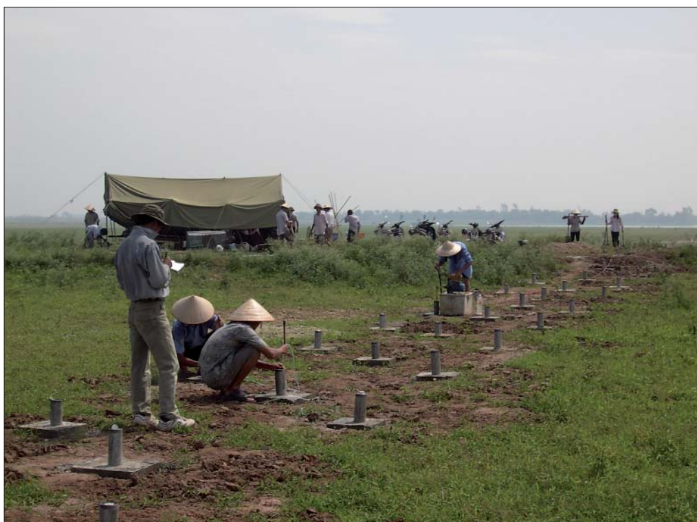
Undersøgelingslokaliteten for arsen i grundvand ved den Røde Flod, 30 km nordvest for Hanoi. Jerrnrørene angiver placeringen af linjen af undersøgelsesboringer. Disse er placeret ved en sidegren til den Røde Flod.
