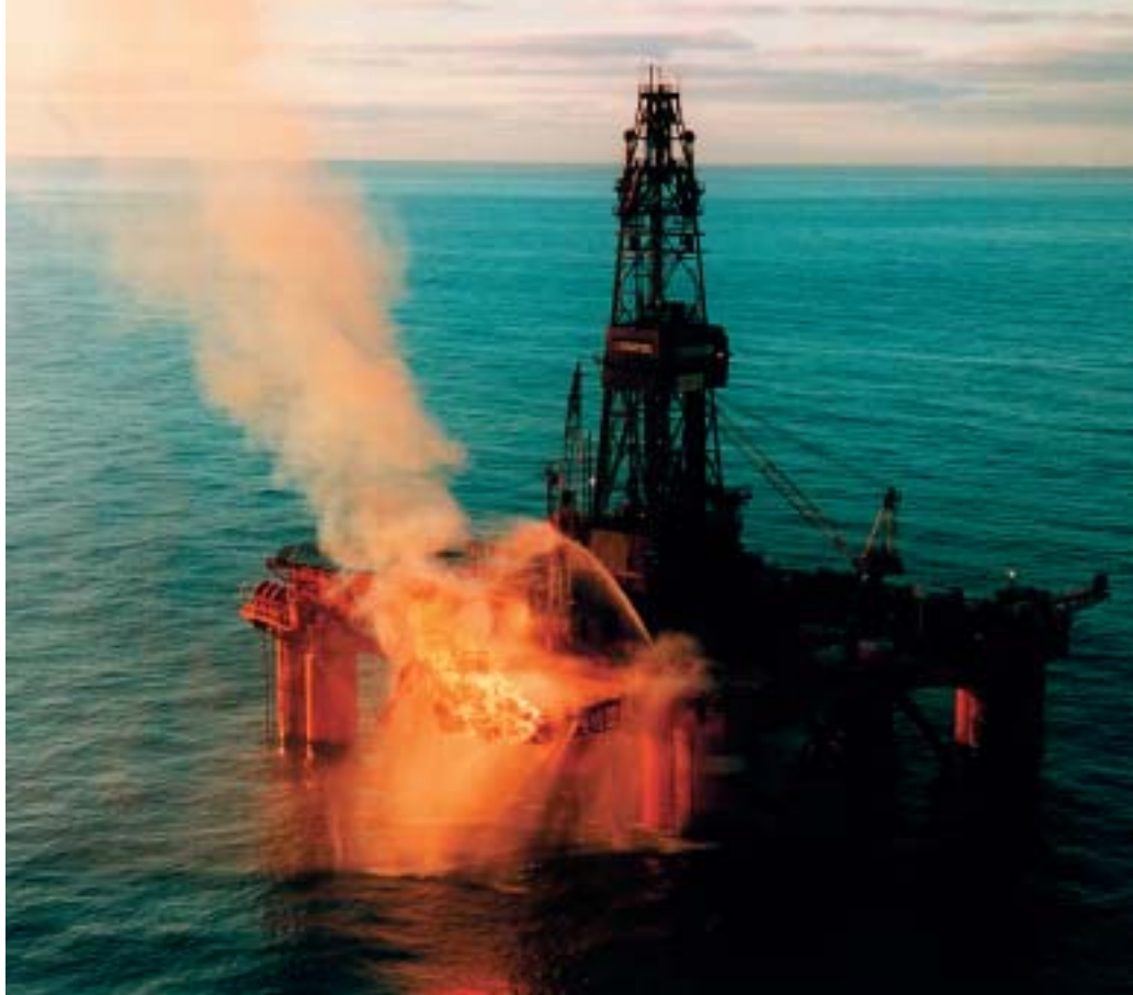
Semi-sub-boreriggen "Deep-sea Bergen" tester olie i den boring, som fandt "Siri-feltet". Operatøren var Statoil, og det foregik i december 1995. Afbrændingen af olien (og dens associerede gasser) udvikler så meget varme, at den del af riggen, der er tættest på brænderbommen, må afkøles med vand. (Foto gengivet med tilladelse fra Statoil Efterforskning og Produktion)
