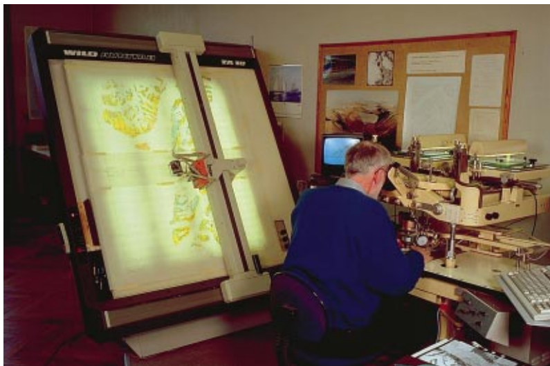
Figur 3. Det stereoskopiske instrumentet opstillet i Kortlægningsafdelingen på GEUS. Til højre sidder geologen fordybet i stereoskopiske betragtninger i det analoge stereorestitution instrument PG2. Stereoskopets mekanik er forbundet med en computer, hvorved en kontinuert registrering af XYZ-kordinater kan opsamles og overføres til såvel plotterbordet som til en database. Flyfotoene er monteret øverst i instrumentet under to lysgivere. Et håndhjul under objektiverne gør det muligt for operatøren af bevæge flydemærket rundt i den tredimensionelle stereomodel. På plotterbordet til venstre ses et udsnit af det geologiske kort over Prinsesse Caroline Mathilde Alper. Hele kortet er udtegnet fra præcist koordinatsatte og oprettede flyfoto-stereomodeller.
